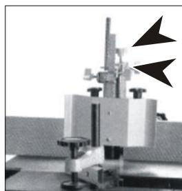
Перед началом работы на оборудовании всегда наденьте и закрепите защитный кожух сверла. Прижимной клапан служит для простоты поддержания направления при обработке. Кожух и клапан установите в требуемое положение и закрепите при помощи ручных болтов.
