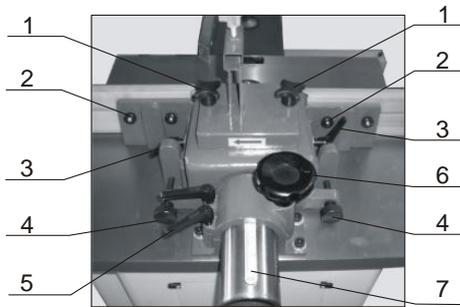
Непосредственно перед началом обработки детали отрегулируйте станок в соответствии с требованием следующим образом: ослабьте болты 1 и откройте крышку, таким образом Вы получите доступ к сверлу для смены инструмента. Болты 2 фиксируют положение алюминиевых линеек.
