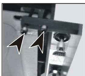
Головки болтов сдвигайте в пазе опорной линейки и зафиксируйте их в требуемом положении. Перемещайте передвижной столик по направляющему рельсу. При помощи имбус-болта
